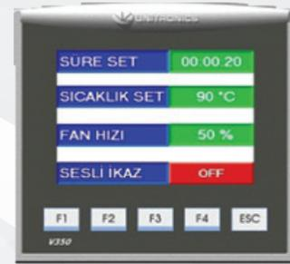
**Kumaş numunelerinin boyama ve yıkama işlemlerinden sonra kurutma ve fiksesi için kullanılır. Kumaş numunelerini sabitlemek için iğneli ve ayarlanabilir çerçeveler mevcuttur. Kurutma işlemi istenilen zaman, sıcaklık ve hava hızı ile gerçekleştirilir İşlem sonunda numune otomatik olarak dışarı çıkarılır. Maksimum sıcaklık 250 °C, maksimum numune ebatları 350 mm x 350 mm dir.**
